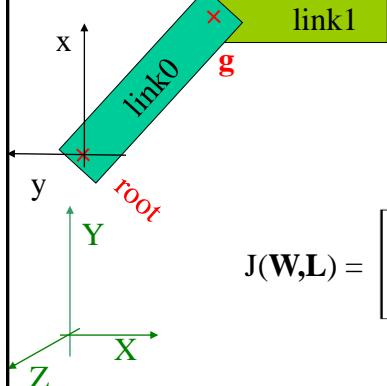
$$J(W, L) = \begin{bmatrix} -l_1 & -l_1 - l_0 \sin(45) \\ 0 & -l_0 \cos(45) \\ 0 & -l_0 \sin(45) \\ 0 & -l_0 \cos(45) \end{bmatrix} \quad \text{Supponiamo: } \alpha = \beta = 45^\circ$$
