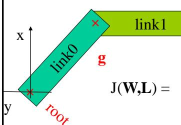
$$J(\mathbf{W}, \mathbf{L}) = \begin{bmatrix} -l_1 & -l_1 - l_0 \sin 45^\circ \\ 0 & -l_0 \cos 45^\circ \\ 0 & -l_0 \sin 45^\circ \\ 0 & l_0 \cos 45^\circ \end{bmatrix} \quad \text{Supponiamo: } \alpha = \beta = 45^\circ$$
