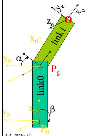
$$b = \begin{bmatrix} \Delta P_{e_x} \\ \Delta P_{e_y} \\ \Delta P_{g_x} \\ \Delta P_{g_y} \end{bmatrix} \quad 4 \times 1 \quad x = \begin{bmatrix} \Delta \alpha \\ \Delta \beta \end{bmatrix} \quad 2 \times 1$$
