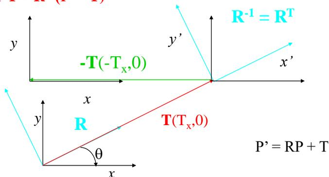
$\mathbf{R}^T \mathbf{T}$  è la proiezione del vettore traslazione sul sistema di riferimento ruotato.
