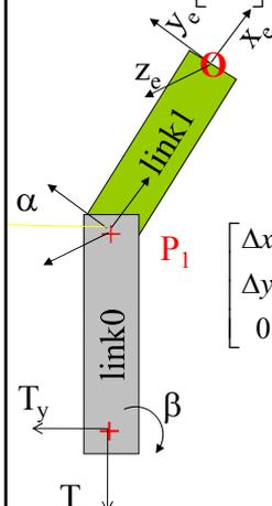
$$\begin{bmatrix} \Delta x_e \\ \Delta y_e \\ 0 \end{bmatrix} = \begin{bmatrix} -2 & -2 & 1 & 0 \\ 0 & -2.5 & 0 & 1 \\ 0 & 0 & 0 & 0 \end{bmatrix} \begin{bmatrix} \Delta \alpha \\ \Delta \beta \\ \Delta T_x \\ \Delta T_y \end{bmatrix}$$
