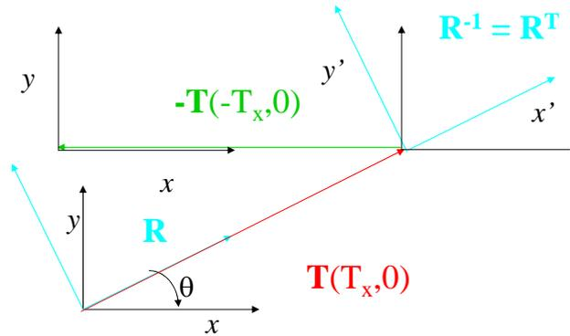
$R^T T$  è la proiezione del vettore traslazione sul sistema di riferimento ruotato.
