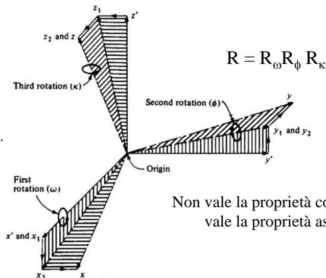
$$R = R_{\omega} R_{\phi} R_{\kappa}$$
