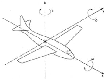
$$R_{\omega} = \begin{bmatrix} 1 & 0 & 0 \\ 0 & \cos \omega & \sin \omega \\ 0 & -\sin \omega & \cos \omega \end{bmatrix}$$
