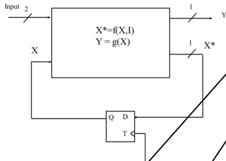
$$X^* = \bar{X} I_1 \bar{I}_0 + \bar{X} I_1 I_0 + X \bar{I}_1 \bar{I}_0 + X I_1 \bar{I}_0 = \bar{X} I_1 + \bar{X} I_0$$
