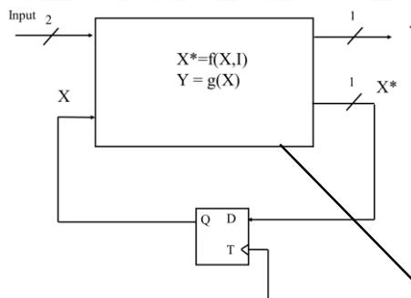
$$X^* = \bar{X} I_1 \bar{I}_0 + \bar{X} I_1 I_0 + X \bar{I}_1 \bar{I}_0 + X I_1 \bar{I}_0 = \bar{X} I_1 + \bar{X} I_0$$
