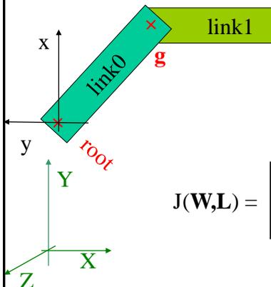
$$b = \begin{bmatrix} \Delta P_{e_x} \\ \Delta P_{e_y} \\ \Delta P_{g_x} \\ \Delta P_{g_y} \end{bmatrix} \quad 4 \times 1 \quad x = \begin{bmatrix} \Delta \alpha \\ \Delta \beta \end{bmatrix} \quad 2 \times 1$$
