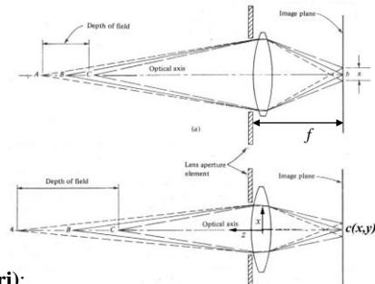
**Parametri di camera (o intrinseci – 3 parametri):**
