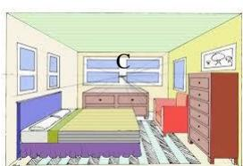
Proiezione centrale: centro di proiezione al finito - C.
