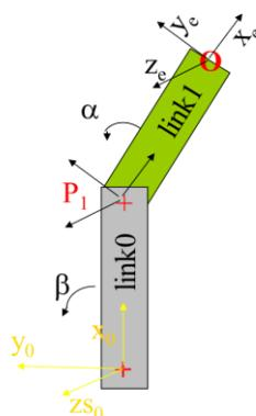
Trasformazione diretta: passo da  $\{X_e, Y_e, Z_e\}$  nel sistema di riferimento end-point a  $\{X_A, Y_A, Z_A\}$  nel sistema di riferimento assoluto.
