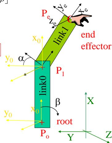
E' possibile spostarsi solamente in direzione perpendicolare al braccio (lungo la perpendicolare al braccio) per  $\alpha = \beta = 0$
