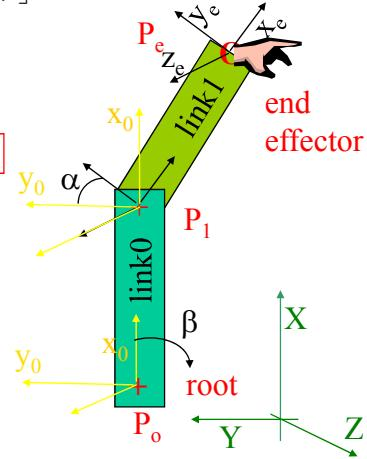
E' possibile spostarsi soltamente in direzione perpendicolare al braccio (lungo la perpendicolare al braccio) per  $\alpha = \beta = 0$
