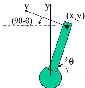
$$\begin{bmatrix} \dot{x} \\ \dot{y} \end{bmatrix} = \begin{bmatrix} \frac{\partial x}{\partial \vartheta} \\ \frac{\partial y}{\partial \vartheta} \end{bmatrix} = \begin{bmatrix} -r \sin \vartheta \\ r \cos \vartheta \end{bmatrix}_{\vartheta=\vartheta_k} \dot{\vartheta}$$
