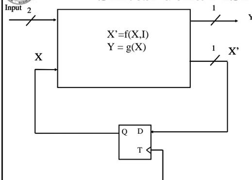
$$X' = \bar{X} i_1 i_0 + \bar{X} i_1 \bar{i}_0 + X \bar{i}_1 i_0 + X i_1 \bar{i}_0 = \bar{X} i_1 + X i_0$$
