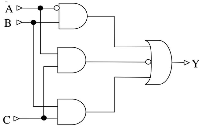
2. Ricavare la forma tabellare , la prima forma canonica e la forma algebrica del seguente circuito semplificando dove possibile.
