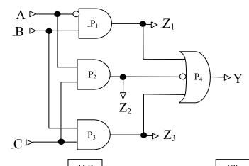
Costruite una tabella con una riga per ogni possibile combinazione degli ingressi ed una colonna con i risultati intermedi per l'uscita di ogni porta logica, ev. aggiungendo ulteriori colonne per il risultato negato (come ~Z<sub>2</sub> nell'esempio).
