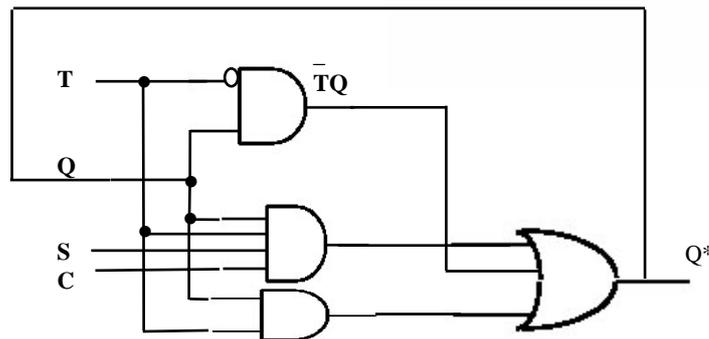
In questo circuito ho anche effettuato delle scelte per cui viene specificata l'uscita per S=C=1. E' un circuito più complesso.
