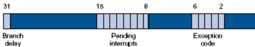
**Branch delay bit:** è 1 se l'ultima eccezione si è verificata in fase di fetch di un'istruzione inserita in un "branch delay slot".
