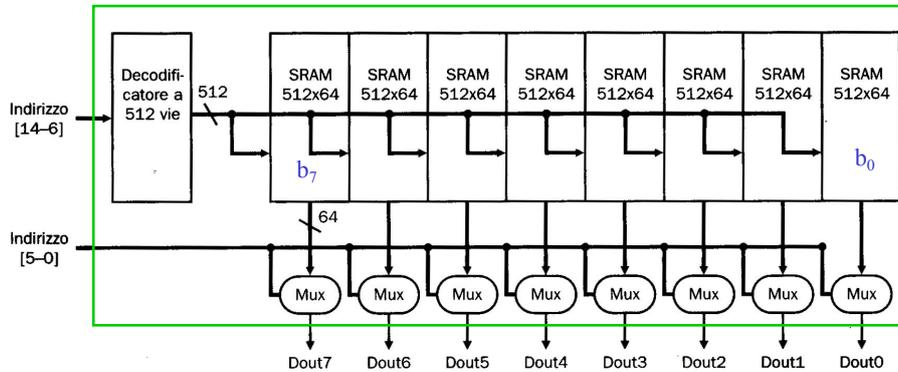
Il decodificatore sarà a 9 bit ( $\log_2 512$ ) per selezionare una delle 512 linee (cf. cache). Ciascuna linea fornisce 64 bit. Ne seleziono uno con il Mux (controllato dai 6 bit meno significativi).
