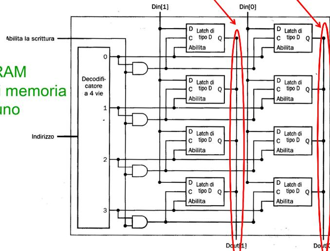
Problemi con il crescere del numero di linee. Esempio: SRAM  $2M \times 16$  ( $2M$  elementi  $\times$  16 bit)
