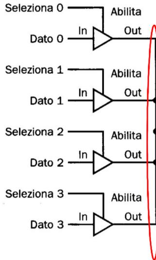
Tutte le uscite delle celle sono collegate ad un'uscita comune  $\Rightarrow$  E' necessario evitare conflitti fra le uscite.
