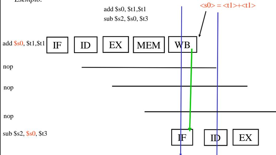
Non eseguo istruzioni per 3 cicli di clock, la pipeline è in stallo per 3 cicli di clock, si formano 3 bolle (bubbles) nel funzionamento della pipeline.
