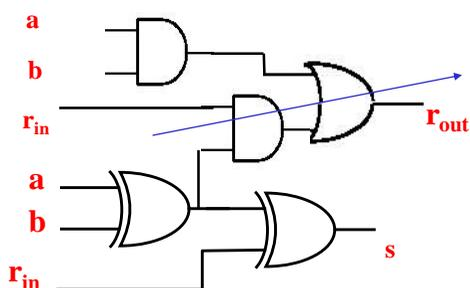
I termini  $a_i b_i$  e  $a_i \oplus b_i$  si possono calcolare a partire dagli ingressi  $\{a_i, b_i\}$  senza aspettare il riporto in ingresso.
