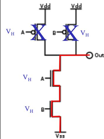
$V_A = 1; V_B = 1 \rightarrow V_{out} = V_{ss} = 0$
