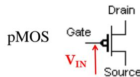
Acceso se:  $V_{in} < V_{dd}/2$
