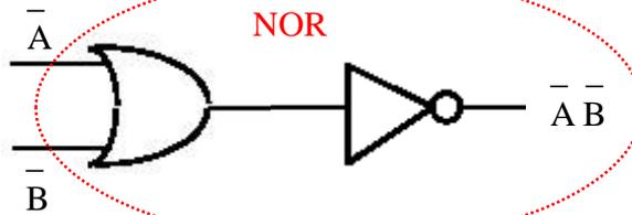
Questo circuito con NOR è equivalente a  $AND(\overline{A}, \overline{B})$ . Come faccio con le negazioni?
