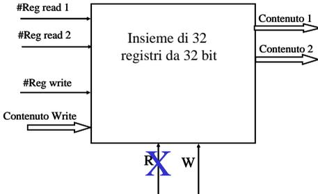
La lettura non modifica il contenuto di un registro (collego uscita Slave con il circuito combinatorio).
