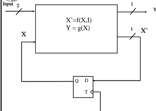
$$X' = \bar{X} i_1 \bar{i}_0 + \bar{X} i_1 i_0 + X \bar{i}_1 \bar{i}_0 + X i_1 \bar{i}_0 = \bar{X} i_1 + X \bar{i}_1$$
