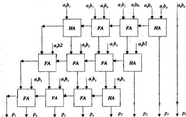
Architettura modulare, ogni schiera di sommatore lavora sul risultato della schiera superiore e fornisce l'input alla schiera inferiore
