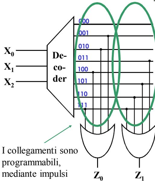
I collegamenti sono programmabili, mediante impulsi elettronici.
