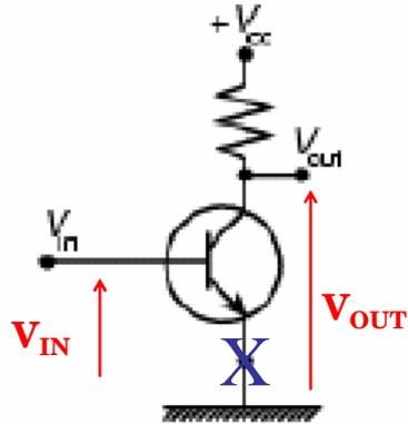
$V_{in} = 0V$  è spento,  $V_{out} = V_{CC}$
