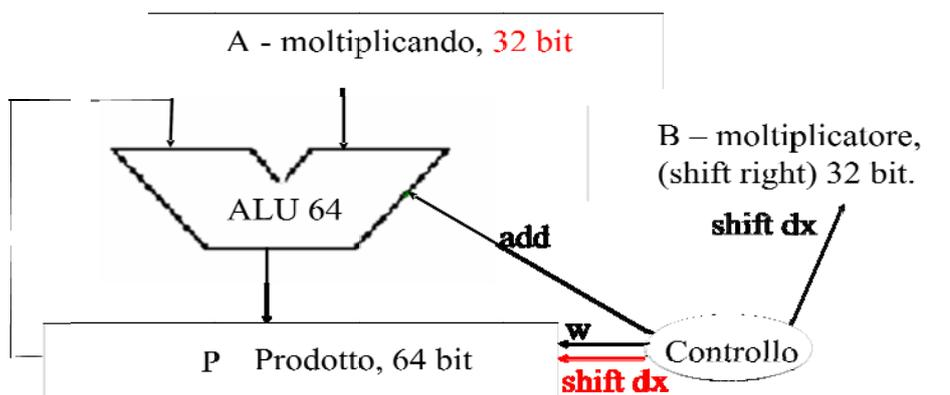
Progettare mediante porte logiche l’unità di controllo, esaminando il suo funzionamento solamente all’interno di un passo di interazione. Non si consideri quindi l’effetto della temporizzazione (clock) che scandisce le iterazioni.
