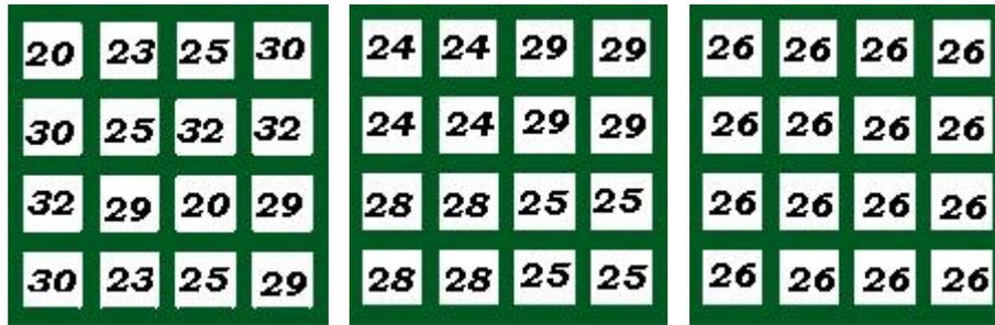
Fig. 10.11 - Osserviamo a sinistra un blocco di pixel preso dall'immagine originale. Al centro lo stesso blocco dopo la prima diminuzione di risoluzione. A destra sempre lo stesso blocco dopo un'ulteriore diminuzione.
